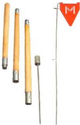
Рис. 5.2. Збірний щуп і прапорець комплексу розмінування
