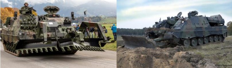
Рис. Д.10.1. Інженерна бронемашини "Pionierpanzer-3 Kodiak" із різними варіантами навісного обладнання
