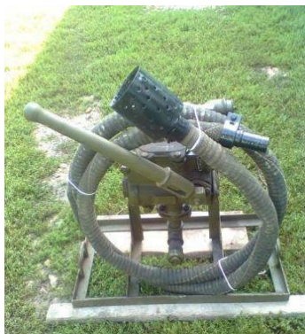
Рис. 5.26. Ручний поршневий насос БКФ-4
