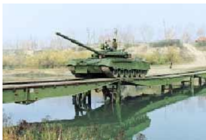
Рис. 2.23. Колійний механізований міст із комплекту ВММ-3М
