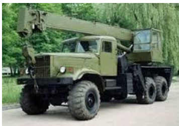
Рис. 4.73. Загальний вигляд автомобільного крана КС-3572
