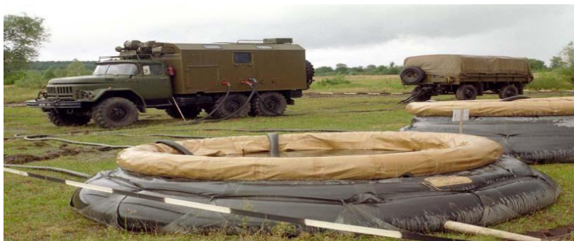
Рис. 5.31. Військова фільтрувальна станція ВФС-10
