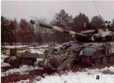
Рис. 2.33. Мінні трали: а – колійний мінний трал КМТ-7, б – колійний мінний трал КМТ-8
