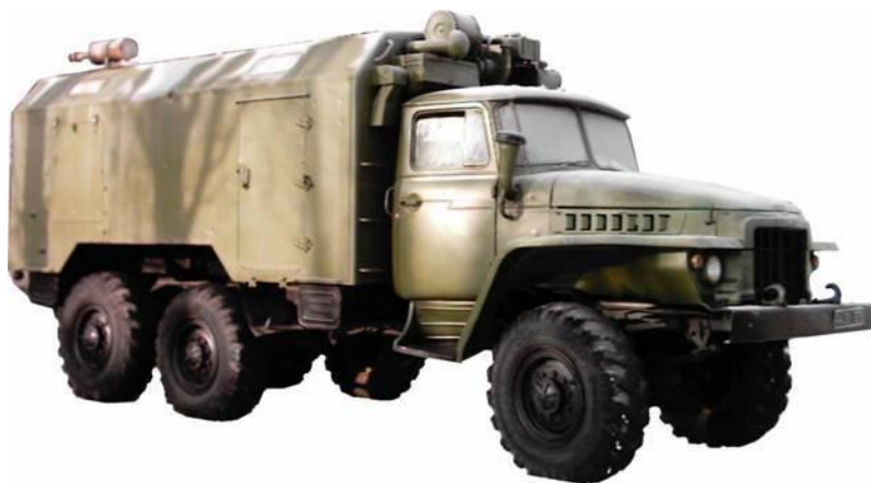
Рис. 5.42. Військова освітлювальна електростанція ЕД- 16-Т/230-1 РАО в кузові-фургоні
