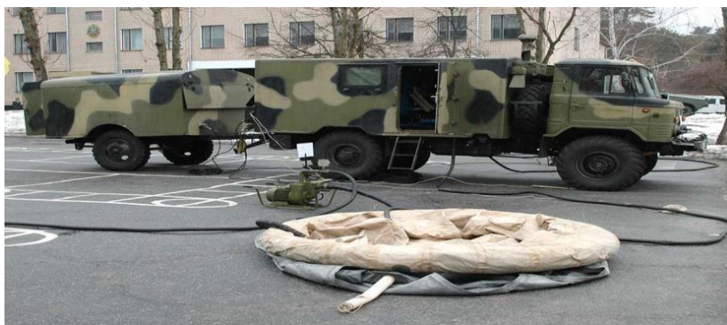
Рис. 5.29. Військова фільтрувальна станція ВФС-2,5
