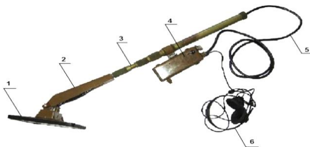
Рис. 5.14. Міношукач РВМ-2, підготовлений для роботи в положенні стоячи: 1 – пошуковий елемент; 2 – держак штанги; 3 – телескопічна частина штанги; 4 – блок оброблення сигналів; 5 – з'єднувальний кабель; 6 – головні телефони
