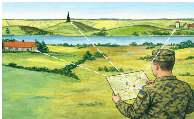
Рис. 7.24. Визначення точки стояння оберненою засічкою
