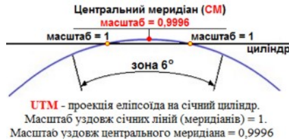
Рис. 5.7. Універсальна поперечно-циліндрична проекція Меркатора (UTM) – типова зона, яка проектується, порядок перерізу: CM – центральний меридіан; лінії перерізу еліпсоїда циліндром
