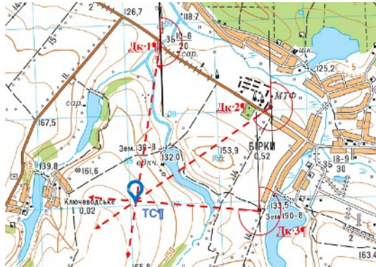
Рис. 7.25. Визначення точки стояння оберненою компасною засічкою
