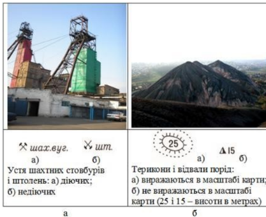
Рис. 3.28. Устя шахтних стовбурів і штольнь, над якими на місцевості встановлені копри (а) і терикони (б) та їх зображення на картах
