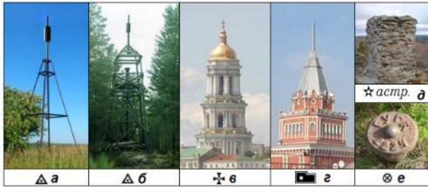
Рис. 3.4. Геодезичні пункти: а) піраміда, б) сигнал, в) на церкві, г) на будівлі; д) астрономічний пункт; е) ґрунтовий репер та їх зображення на картах
