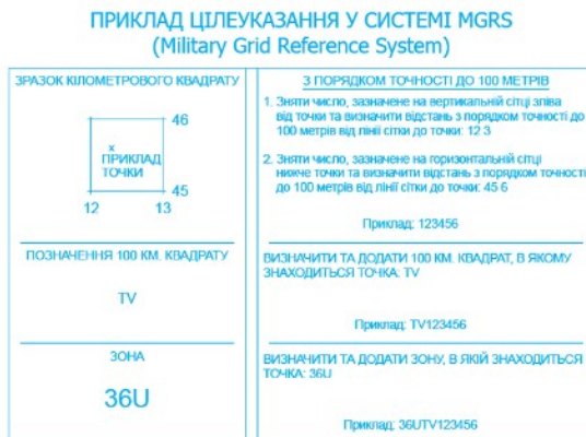
Рис. 5.13. Пояснення на топографічних картах щодо практичного використання системи цілевказання MGRS (з точністю до 100 м)
