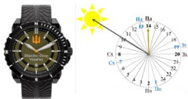
Рис. 7.4. Порядок визначення сторін горизонту за астрономічним циферблатом
